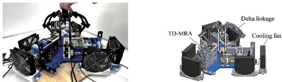
図 4 DH-MRD 二次試作機
