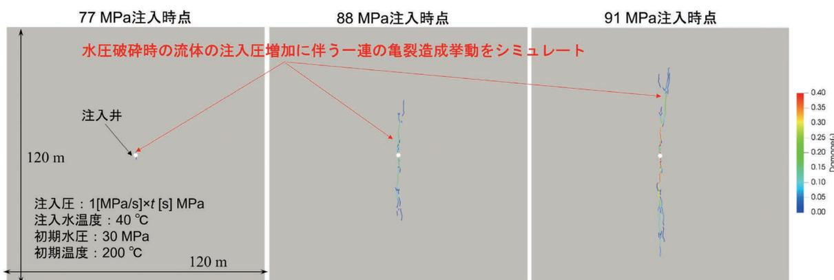
図6 高温岩盤での水圧破碎時の造成亀裂の進展挙動
