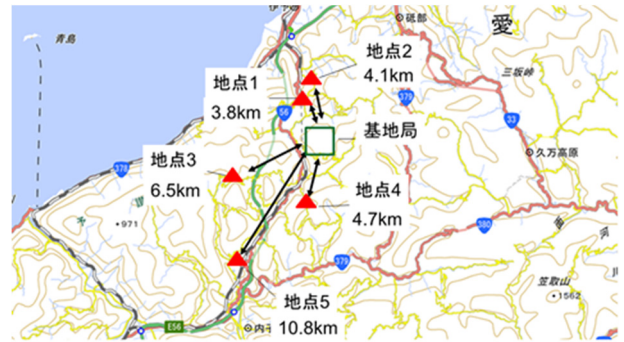
図1 電波伝搬試験検証箇所
